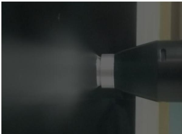
Ottima penetrazione con un ventaglio di spruzzatura ridotto
