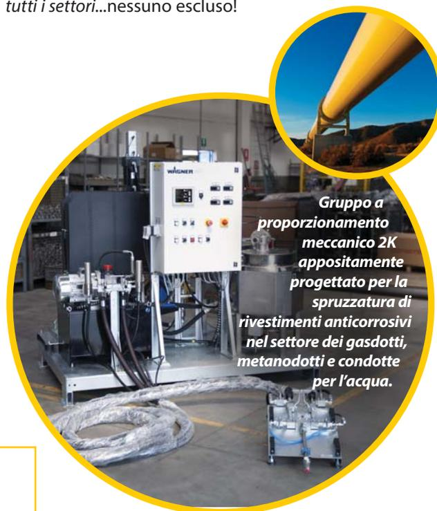
**Gruppo a proporzionamento meccanico 2K appositamente progettato per la spruzzatura di rivestimenti anticorrosivi nel settore dei gasdotti, metanodotti e condotte per l'acqua.**
